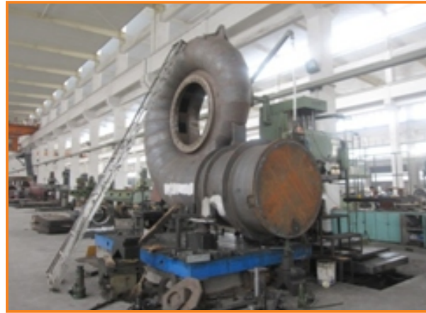
Chế tạo buồng xoắn tua bin Manufacturing of spiral case
